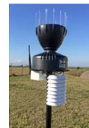
Sevépi propose des stations météo connectées via le réseau Sencrop, en partenariat avec la chambre d'agriculture d'Ile-de-France. Ces stations Sencrop collectent des données telles que la température de l'air, l'hygrométrie, la pluviométrie ou encore la vitesse du vent.
